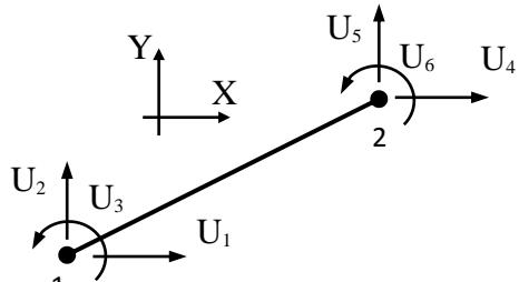
$$\begin{bmatrix} u_1 \\ v_1 \\ \theta_1 \\ u_2 \\ v_2 \\ \theta_2 \end{bmatrix} = [R]_{VB} \begin{bmatrix} U_1 \\ U_2 \\ U_3 \\ U_4 \\ U_5 \\ U_6 \end{bmatrix}$$
