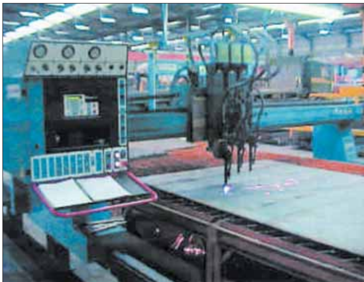
Máquina de Oxicorte com Comando Numérico
