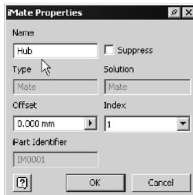
Um conjunto idêntico de iMates também existe no disco do travão. Seguidamente, irá colocar outra instância do suporte e usar os iMates para o restringir automaticamente ao disco do travão.
