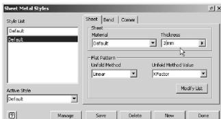
1. Na barra de Painel, clique na ferramenta **Sheet Metal Styles**.
